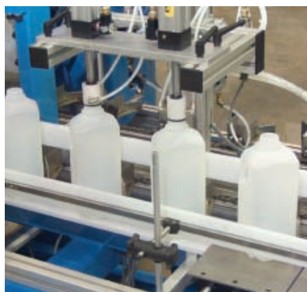
Estación integrada para prueba de fugas con expulsión de botellas opcional
