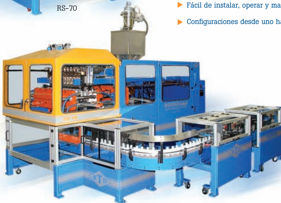
Maquina RS-70 con descolado y cortador de domos modelo HT1
