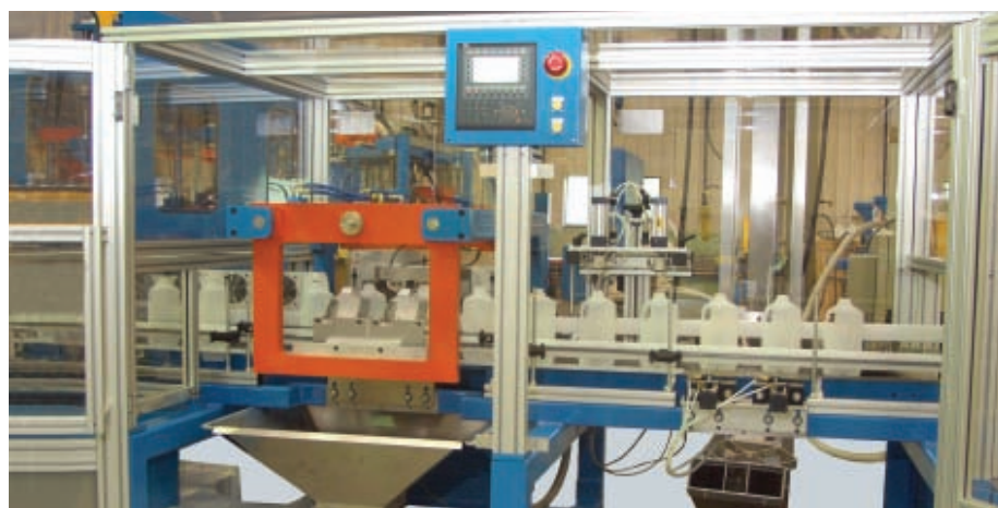
Tolva recolectora de rebabas por medio de soplador o banda transportadora.
